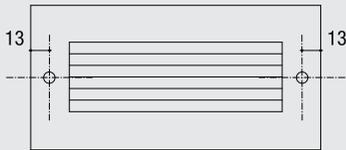
Gitter mit **A-Bohrung**
