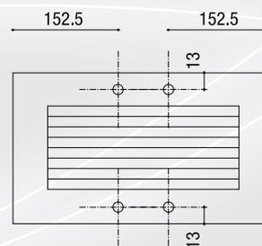
Gitter mit **F-Bohrung**
