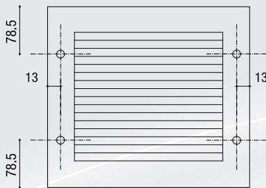
Gitter mit **C-Bohrung**
