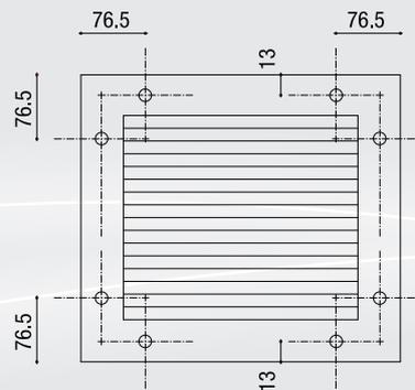
Gitter mit **C+G-Bohrung**
