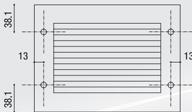
Gitter mit **D-Bohrung**
