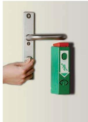
Berechtigte Personen benutzen zur Begehung des Notausgangs nicht den Drücker, sondern öffnen das Panik-Schloss mit dem Schlüssel via Wechselfunktion. Dabei wird kein Alarm ausgelöst.
