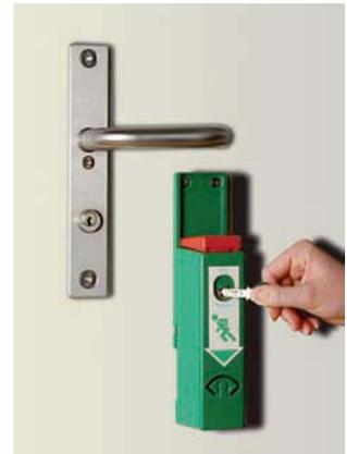
Soll der Notausgang für eine gewisse Zeit frei begehbar sein, so kann eine berechtigte Person den EH Exit-Controller mittels Schlüssel alarmfrei in Dauerfreigabe-position verschieben und bis zur Rückstellung arretieren.
