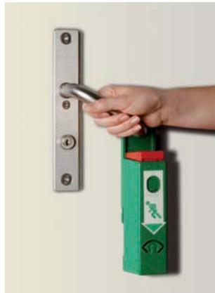
Beim Herunterdrücken des Drückers verschiebt sich der EH Exit-Controller senkrecht nach unten und das Panik-Schloss entriegelt. Der Notausgang ist mit einem einzigen Handgriff geöffnet. Ein Alarm wird ausgelöst.
